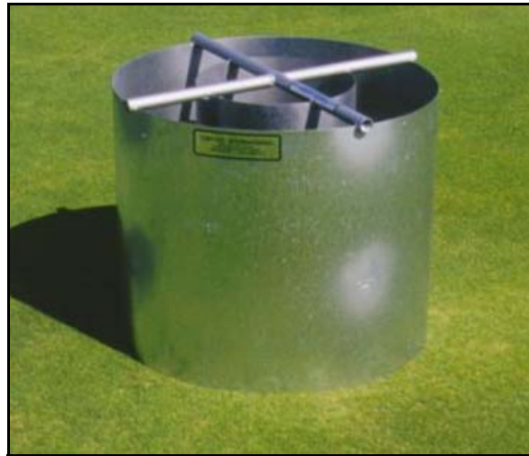
Figura 5.1 Infiltrômetro. Fonte: Collischon, 2008.
