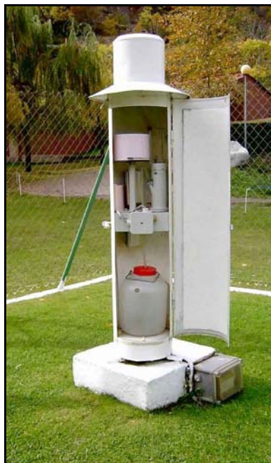
Figura 3.2 Foto de um Pluviômetro. Fonte: FAEM-UFPEL, 2009.
