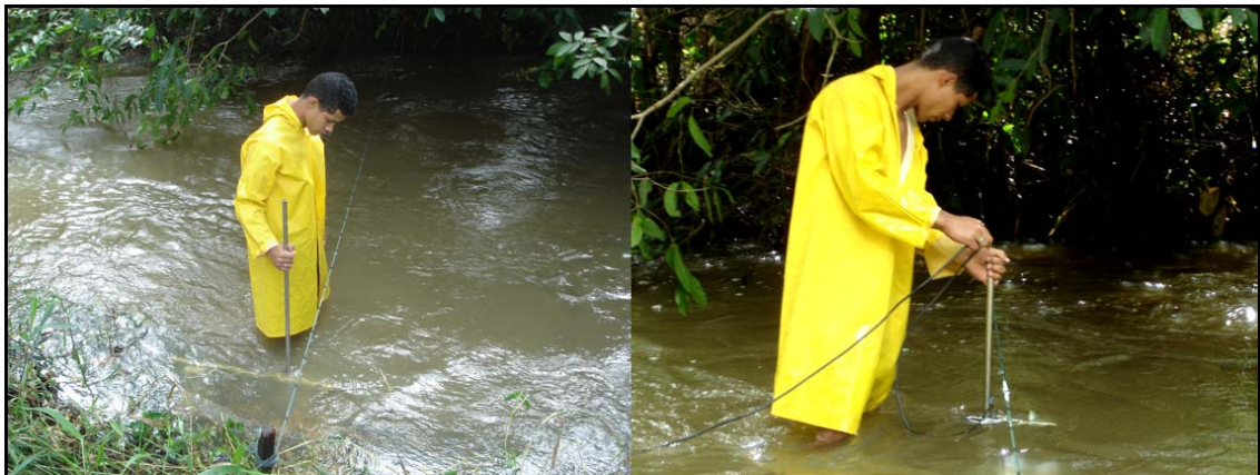
Figura 6.10 Medição de vazão com molinete.
